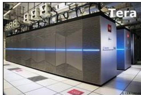
Le supercalculateur Tera à Valduc : 25 \times 10^{15} opérations par seconde
